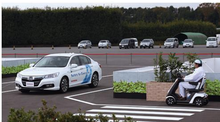
電動カートとWi-Fiで通信。死角に潜んでいるカートを察知し、自動ブレーキで回避しました。
