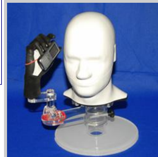
SAR試験 人体と同じ電気特性を持った液体が頭部に入ってます。
